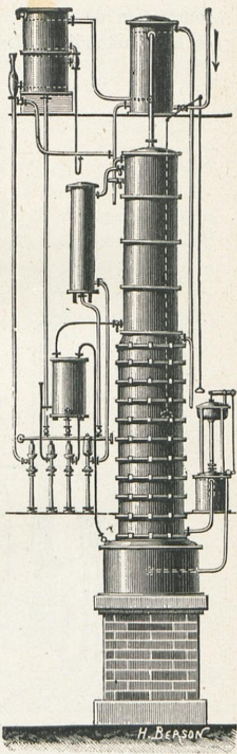
FIG. 78. — Colonne à haut degré (système Barbet).
