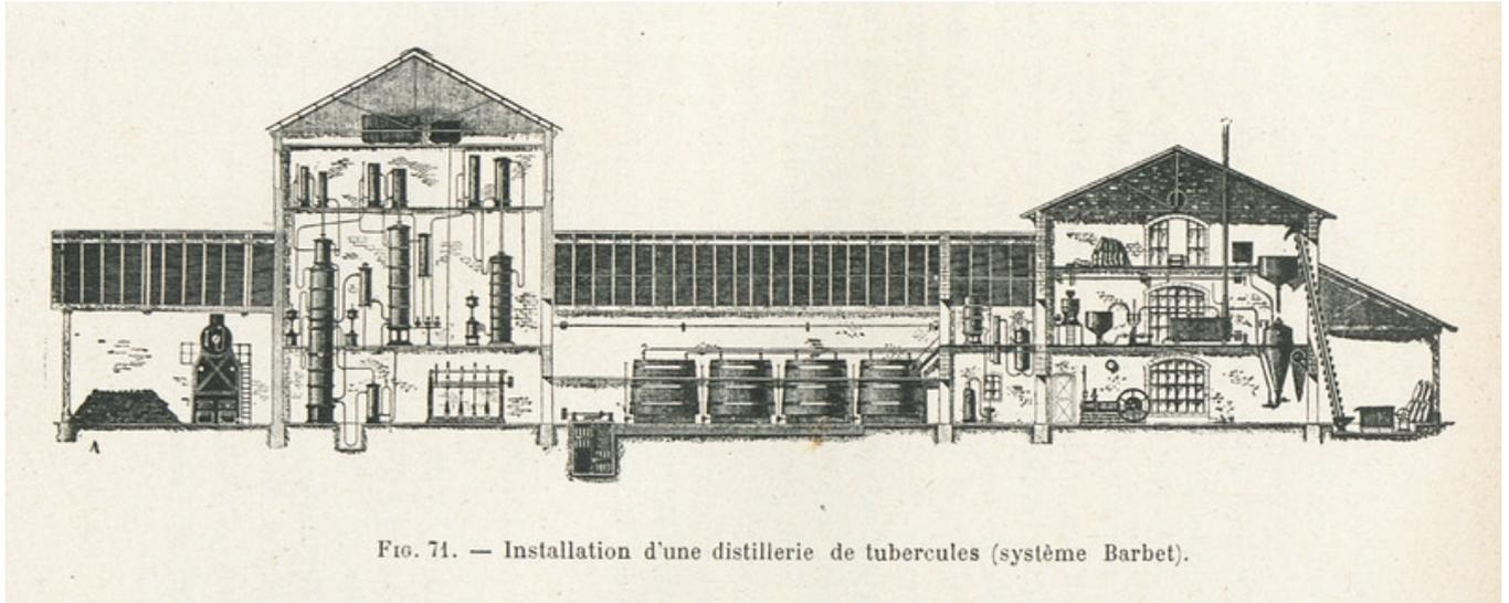
FIG. 71. — Installation d'une distillerie de tubercules (système Barbet).
